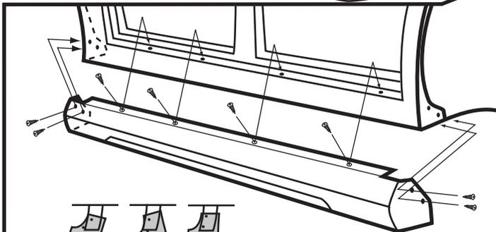
ドアを開けた状態でサイドスカートボディのステップ部、フェンダー部に合わせ、上面とフェンダー部の自立たないカ所に穴を開け(上面：3、4カ所フェンダー部：各2カ所)サイドスカートを正確にセットしているかを確認してからタッピングビスで固定して下さい。
