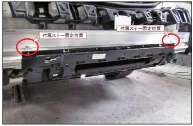
インナーパーツを車両に合わせて底面部分の固定位置を元の純正ボルトで固定し、上部(画像丸印の位置)を付属ステーでホースメントに固定して下さい。
