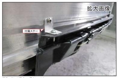
画像の様に付属ビスで固定して下さい。 ※ホースメント側は付属ビスに適した下穴をドリル等で開けて下さい。
