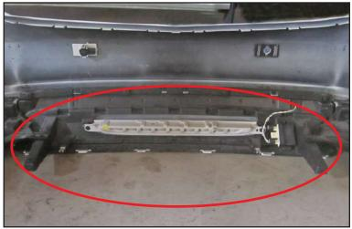
純正リアバンパーから画像丸印の部分のインナーパーツを取り外して下さい。
