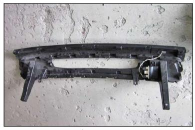
取り外したインナーパーツからLEDランプを取り外して下さい。 ※LEDランプはスポイラーの内側にコーキングボンド(別売)で接着して固定します。
