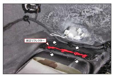
LEDランプと同じ様にリアバンパー内側から左右の開口部に純正リフレクターを合わせ、コーキングボンド等(別売)でリアバンパーに接着して下さい。
