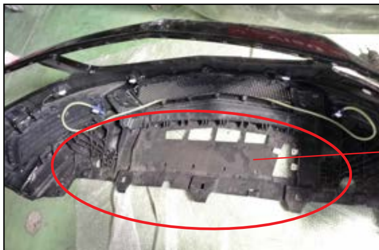
バンパー底面(画像丸印の部分)のアンダーカバーを取り外しスポイラーへ移植して下さい。
