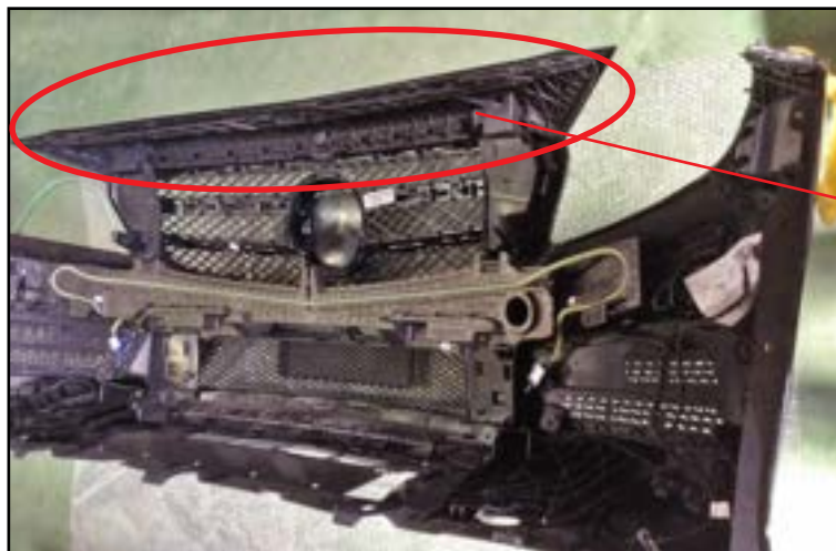
グリル上部(画像丸印の部分)のインナーパーツを取り外しスポイラーへ移植して下さい。
