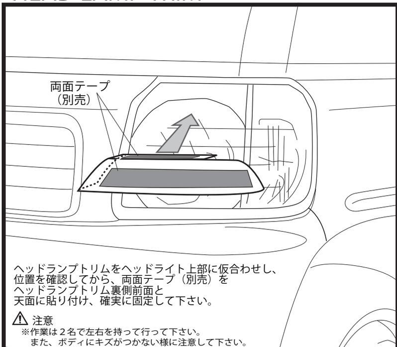
ヘッドランプトリムをヘッドライト上部に仮合わせし、位置を確認してから、両面テープ(別売)をヘッドランプトリム裏側前面と天面に貼り付け、確実に固定して下さい。
