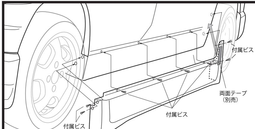
ドアを開けた状態でサイドスカートボディのステップ部、フェンダー部に合わせ、上部とフェンダー部の目立たない箇所にドリルで穴を開け(上部：4カ所、フェンダー部前後2カ所ずつ)付属ビスで、サイドステップ後部の突起部を両面テープ(別売)で確実に固定して下さい。
