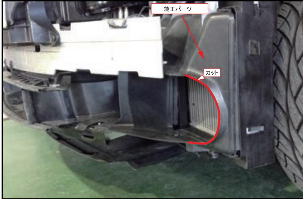
画像のカットラインを参考に純正パーツを加工して下さい。(左右同様)
