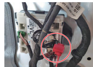
デモカーはドア内張りを外し、ドアミラーロゴプロジェクターの配線に結線しております。
